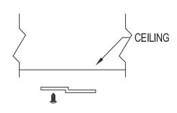
4. SLIDE THE EC-1 BRACKETS ON THE PANELS ONTO THE EC-2 / EC-4 BARS ON THE CEILING.
